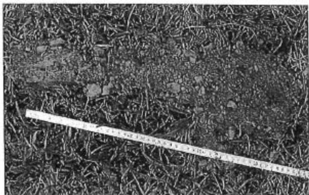
Sondage 1 : Sol assez homogène mais caillouteux, limoneux-argileux jusqu'à 40 cm de profondeur (fin du sondage). Absence de trace d'oxydo-réduction.
